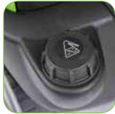
Eingebauter Reinigungsmitteltank mit einem Inhalt von 7,5 l, mit dem das Produkt bei Niederdruck abgegeben werden kann.
